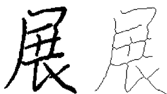
图11 细化导致的笔段缺失示例
